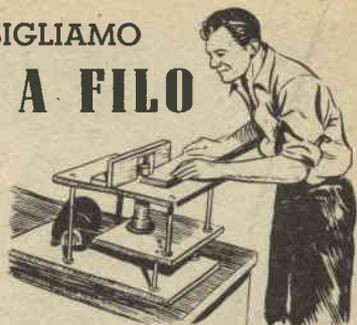
è sufficiente a fornire la potenza necessaria per lavori medi, ed andrà smontato su di una base orizzontale, la trasmissione essendo assicurata a mezzo di due pulegge, una del diametro 75 mm., per un motore con velocità di 3.500 g. m., sistemata sull'asse del motore stesso, l'altra da 25 mm., solidale all'asse dell'utensile cosicché con la semplice inversione della direzione della cinghia, sarà possibile invertire il senso di rotazione del ferro.
